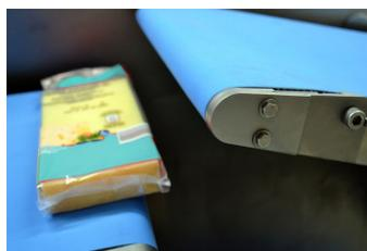
Éjecteur par poussoir pneumatique : La réalisation très compacte de ces éjecteurs permet de les installer sur la structure de la trieuse en face du tapis de sortie.
